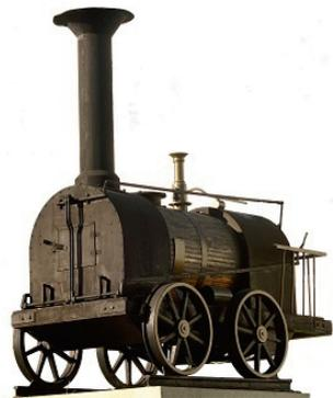
Первый паровоз в России был построен отцом и сыном Е. А. и М. Е. Черепановыми в 1833 г., на два года опередившими постройку первого паровоза в Германии. Он выгодно отличался от зарубежных паровозов оригинальными удачными конструктивными решениями. Этот паровоз перевозил до 3,2 т груза со скоростью около 16 км/ч, второй паровоз, построенный в 1835 г., мог возить груз уже в тысячу пудов (16,4 тонн) со скоростью 16,4 км/ч.
